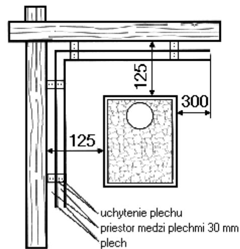
4. Minimálna vzdialenosť pece od nehorľavej steny musí byť aspoň 50 mm.
