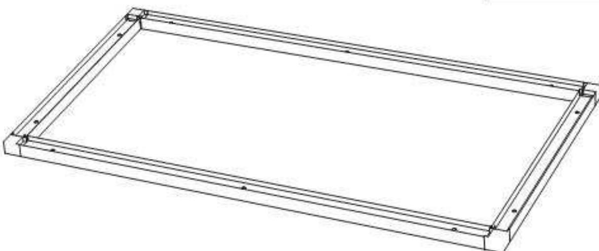
**2** Otočte podlahový rám naopak. Zaňaďte rohové spoje do podlahových rámových profilov. Uistite sa, že sú vždy smerom dovnútra. Upevňte rohové spoje a namontujte väčšie nastaviteľné nožky smerom dovnútra.
