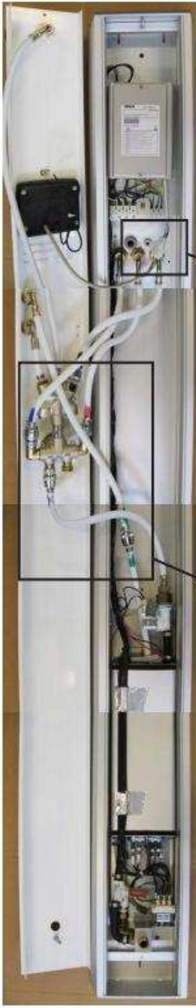
Odpojte prívod energie a 5 rýchlospinacích spojok pre vodu (2x modrá, červená, zelená a hnedá). Veko odložte preč.
